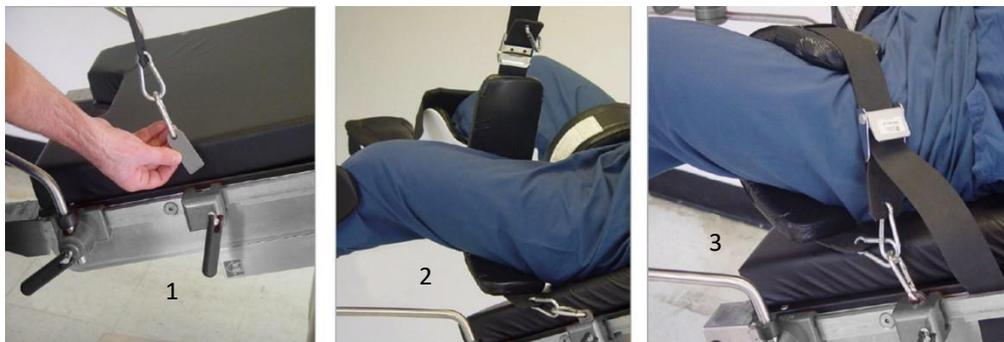
1. Fissare i Morsetti semplici (venduti separatamente) alle guide laterali del tavolo. Inserire i perni di montaggio nei morsetti e bloccarli saldamente in posizione.
